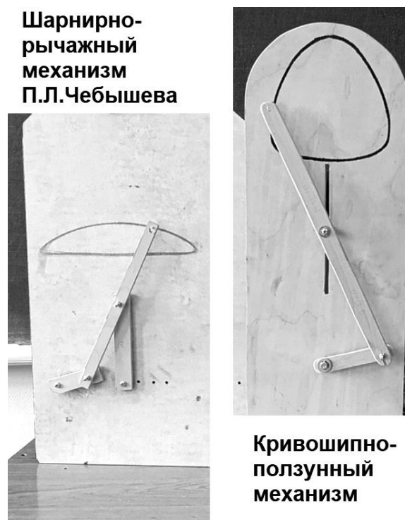
Рис. 8. Иллюстрация эффекта увеличения высоты шага в новом механизме
