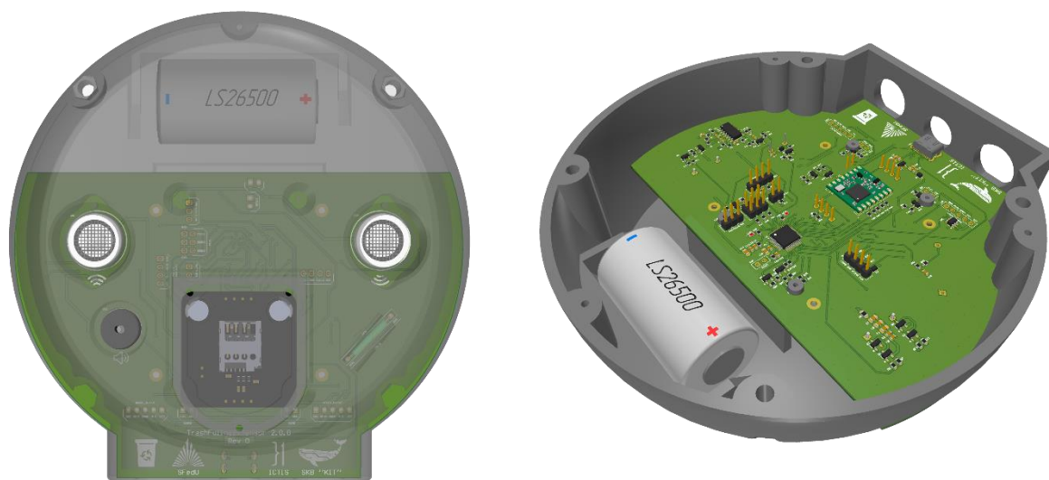
Рис. 1. Датчик наполненности мусорного контейнера
