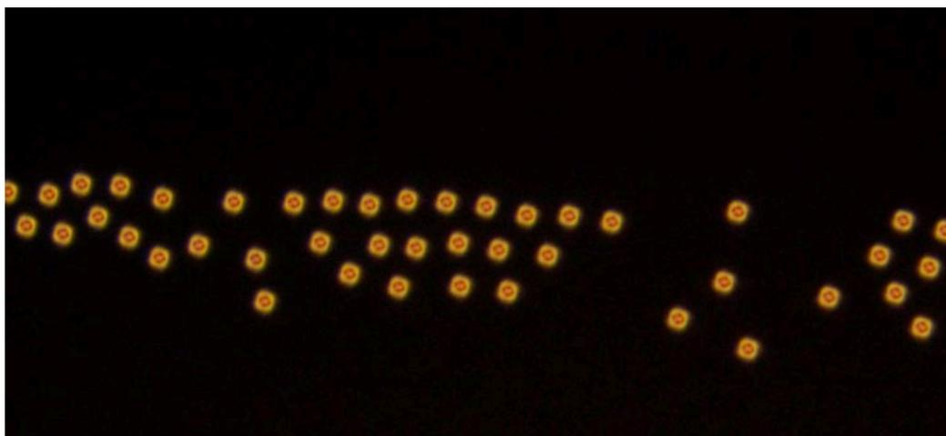
Рис. 2. Локализованные хиральные структуры за границей электрода после отключения приложенного электрического поля. Условия наблюдения: объектив 20х, скрещенные поляризаторы
