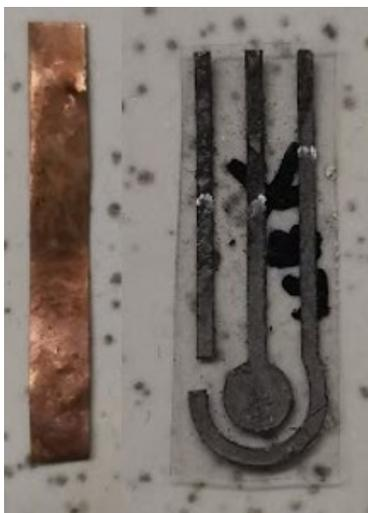
Рис. 1. Общий вид графитовой тест полоски и медной пластинки как электрода сравнения
