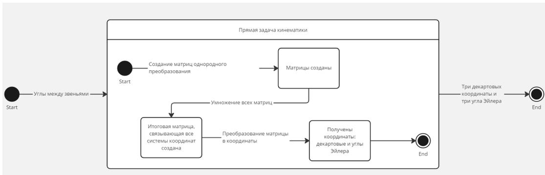
Рис. 1. UML схема состояний для ПЗК
