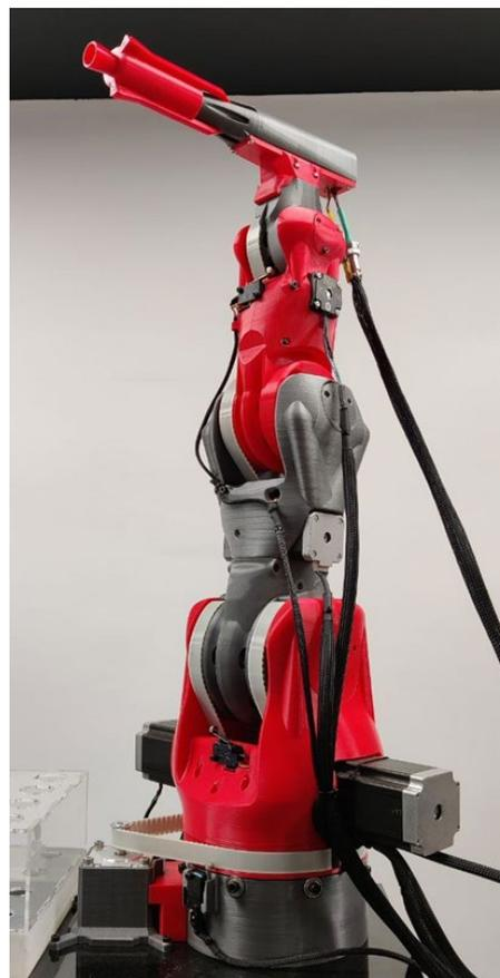
Рис. 2. Полностью модифицированный BCN3D с установленным дозатором для проведения химических экспериментов
