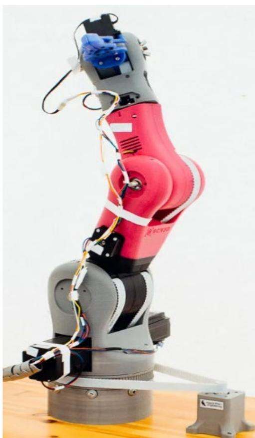
Рис. 1. Манипулятор BCN3D в стандартном исполнении [2] со схватом
