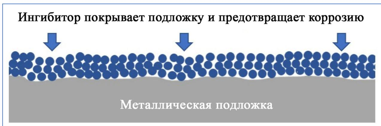
Рис. 1. Действие ингибитора коррозии [4]
