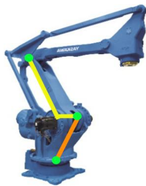
Рис. 3. Представление звеньев робота прямой или набором прямых
