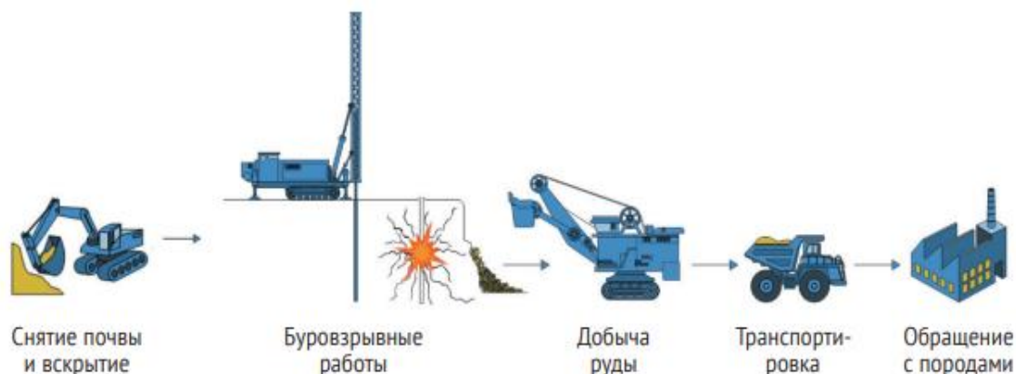
Рис. 2. Технологический процесс добычи и транспортировки бокситовой руды
