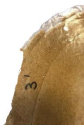
Рис. 6. Биоразлагаемый материал, полученный с использованием рисовой шелухи в качестве наполнителя (образец рецептуры №8), ламинированный слоем PLA
