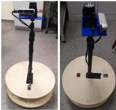
Рис. 2. Фотография разработанного робота для 3D-сканирования
