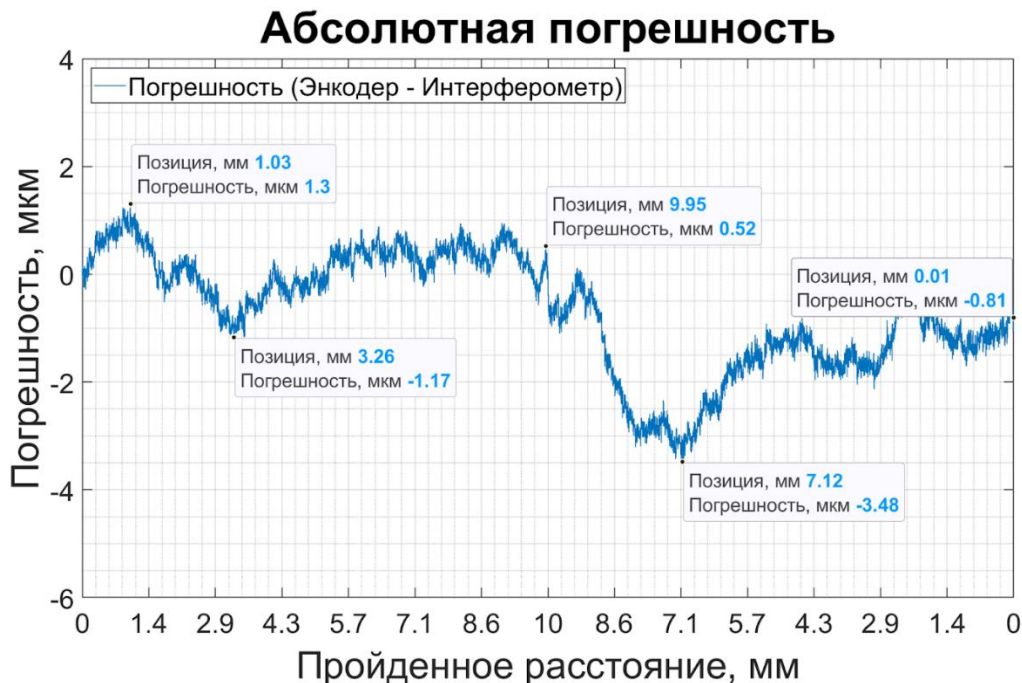
Рис. 3. Погрешность вычисления перемещения макета оптического энкодера
