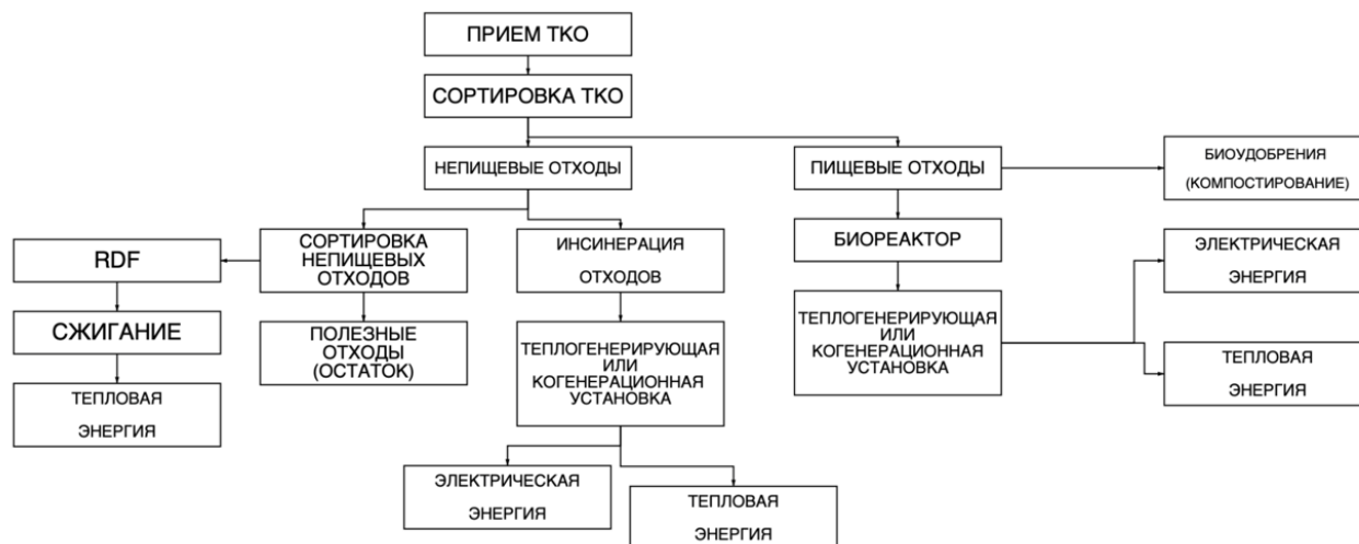
Рис. 2. Принципиальная технологическая схема утилизации ТКО с получением энергии на полигоне «Чемодановка» Пензенской области
