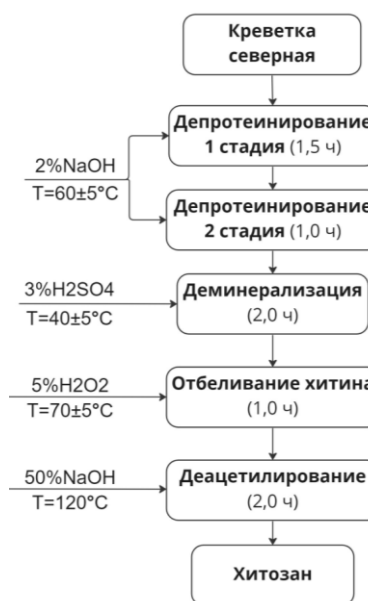
Рис. 2. Схема получения хитозана из креветки
