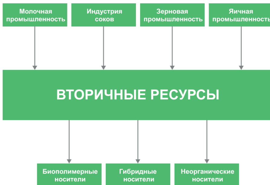
Рис. 1. Источники вторичных ресурсов и типы носителей для иммобилизации ферментов на их основе
