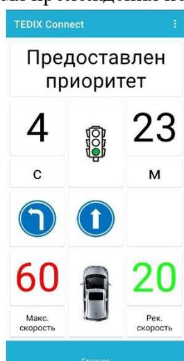
Рис. 3. Интерфейс HMI, разработанный компанией Fort Telecom. Сценарий «Предоставление приоритетного проезда ОТ»
