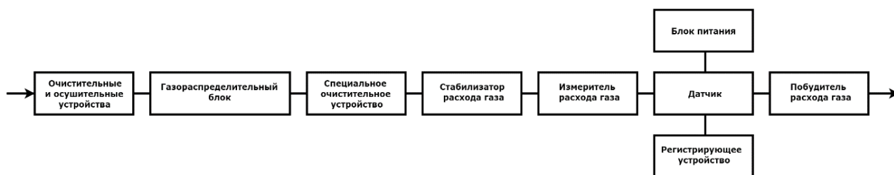
Рис. 1. Структурная схема автоматической газоаналитической системы
