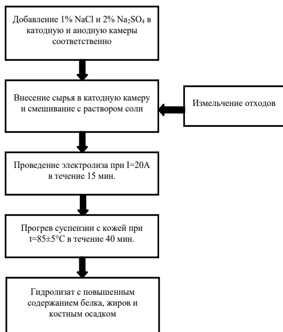
Рис. 1. Технологическая схема получения белковых гидролизатов из отходов от рыбопереработки электрохимическим способом
