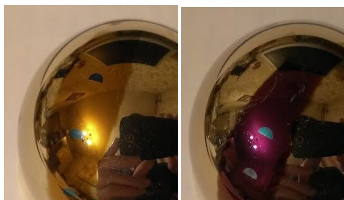
Рис. 3. Локальное напыление хромового покрытия на сферический ротор: 4,5 минуты – слева, 9 минут – справа
