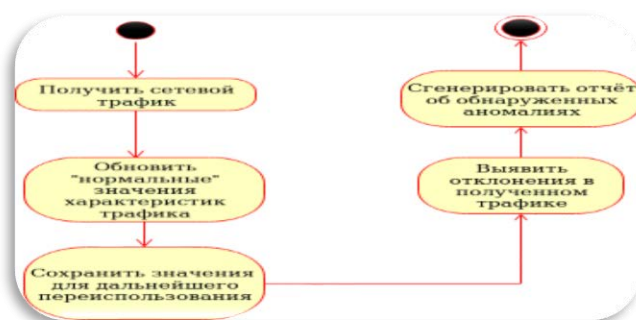
Рис. 1. Принцип работы модуля анализа сетевого трафика
