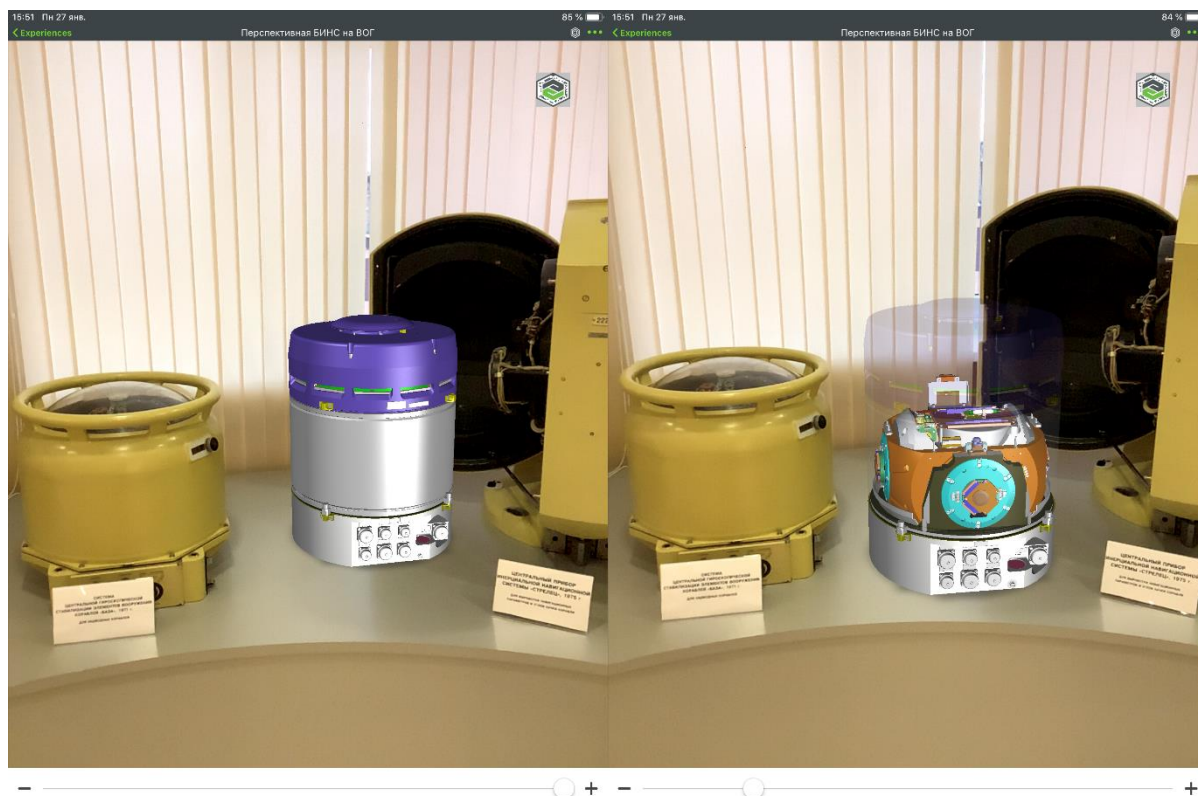
Рис. 3. Демонстрация компоновки и габаритных размеров БИНС
