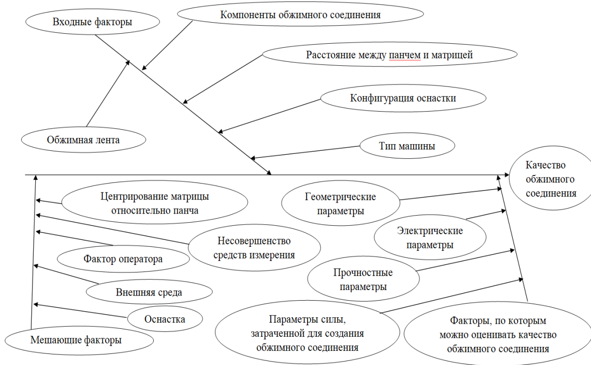
Рисунок. Диаграмма Исикавы, направленная на решение проблемы качества обжимных соединений
